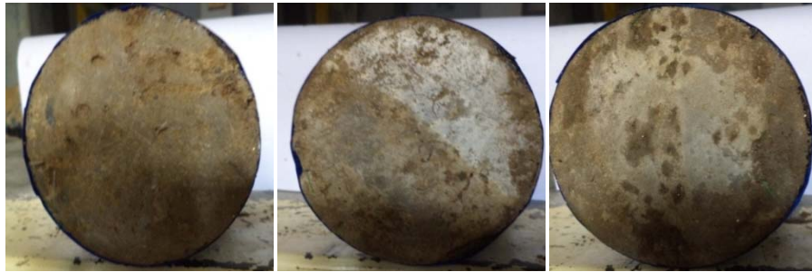
(a) Cement : 5% (b) Cement : 10% (c) Cement : 15%
