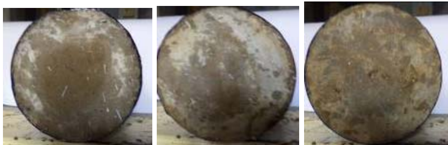
a). Cement : 5%, (b) Cement : 10%, (c) Cement : 15%
