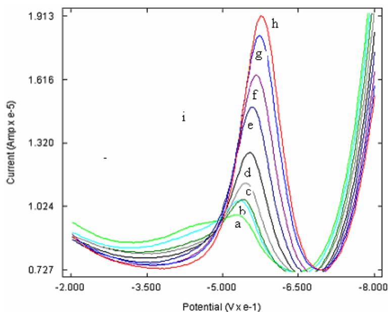
**Figure 8.23** Differential Pulse Voltammogram of NIM of different concentrations a)  $1 \times 10^{-6}$  M b)  $5 \times 10^{-6}$  M c)  $7 \times 10^{-6}$  M d)  $9 \times 10^{-6}$  M e)  $2 \times 10^{-5}$  M f)  $6 \times 10^{-5}$  M g)  $8 \times 10^{-5}$  M h)  $1 \times 10^{-4}$  M at AuNP/poly-CA/GCE at  $25^{\circ}\text{C}$
